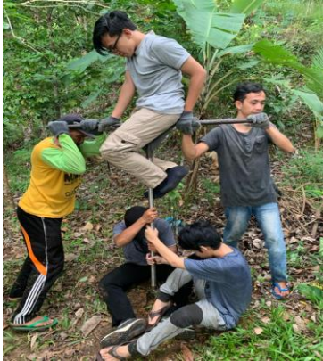
Gambar 4. Pengambilan data sampel tanah di lapangan dengan menggunakan Auger (Bor tangan).
