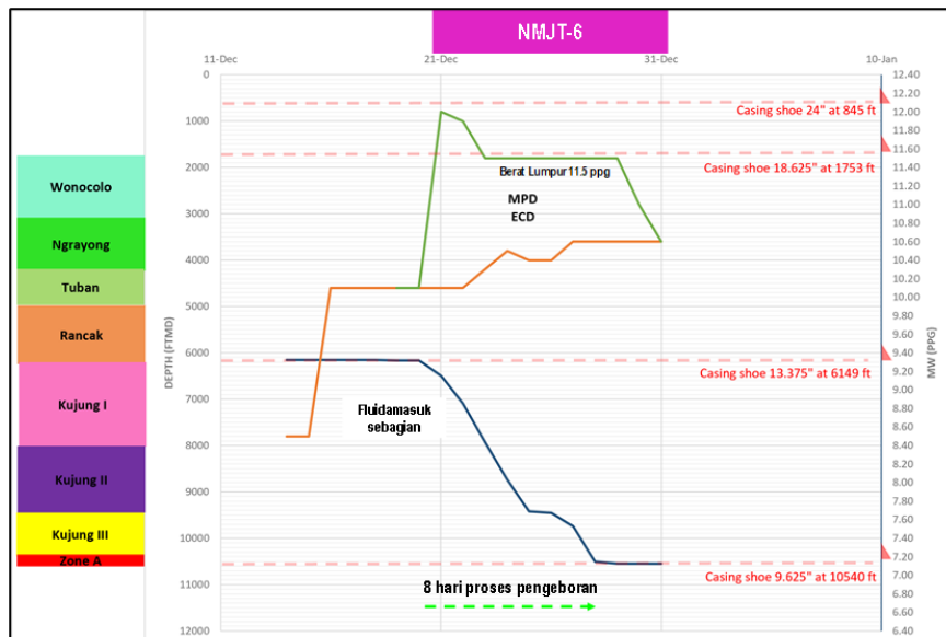
Gambar 19. Plot yang menunjukkan kemajuan kedalaman (ft) sumur dengan waktu pengeboran (hari), menunjukkan pengeboran interval Formasi Kujung-1 sampai Kujung-3 diselesaikan dalam waktu 8 hari dengan berat lumpur maksimal 11.5ppg dan tidak terdapat rontokan sumur.
